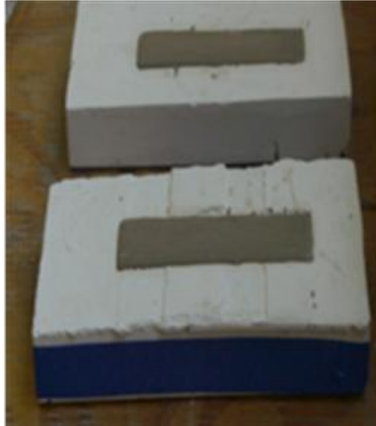
Figura 2.5. Ilustración del molde de yeso utilizado en la obtención de probetas en verde de las mezclas establecidas.
