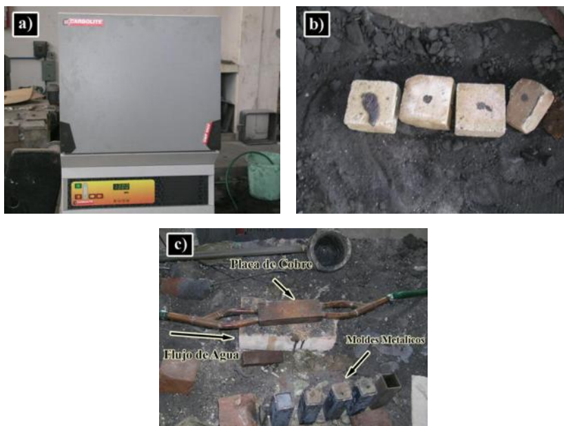
Figura 2.2.- Fotografías donde se muestra el horno (a) empleado para calentar los tabiques refractarios (b), y el dispositivo para generar la solidificación direccional (c).
