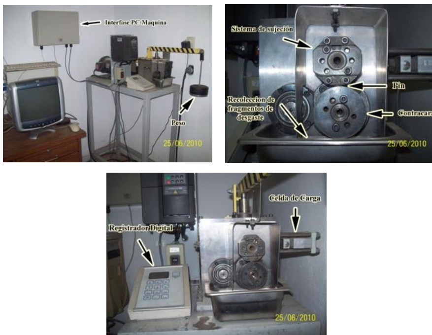
Figura 2.10.- Detalles de la máquina de desgaste utilizada para el ensayo de los hierros blancos.
