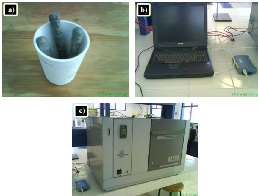
Figura 2.9.- Equipo utilizado para el Análisis Térmico, donde se utilizó un crisol de alúmina para fundir las aleaciones (a), sistema de adquisición de datos (b) y horno de alta temperatura utilizado para refundir las aleaciones (c).
