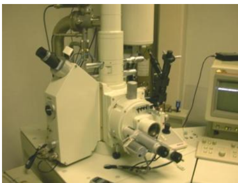
Figura 2.6.- Microscopio electrónico de barrido JEOL 6400 utilizado para la caracterización del material.
