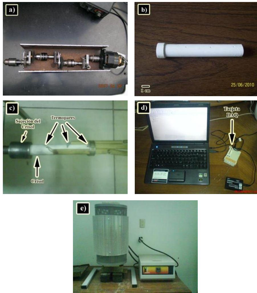
Figura 2.3.- Transmisión de la maquina de solidificación direccional (a), crisol de alúmina para refundir las aleaciones (b), crisol y termopares S listos para el ensayo de solidificación direccional (c), sistema de adquisición de datos para registrar el gradiente de temperatura G (d) y horno vertical de resistencias eléctricas (e).
