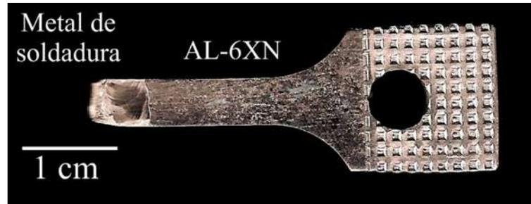
**Figura 49** Macrografía probeta fracturada a tensión.
