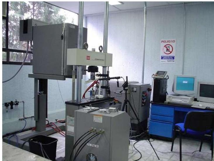
**Figura 24** Máquina servohidráulica MTS para ensayos de tensión y fatiga
