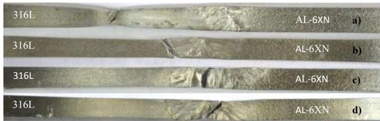
**Figura 59** Imágenes de localización de la fractura como función del porcentaje de acumulación de daño en soldaduras disímiles 316L/AL-6XN. Imagen a) BAT bajo aporte térmico con 75%. Imágenes a), c) y d) AAT alto aporte con 0%, 50% y 75%, respectivamente.
