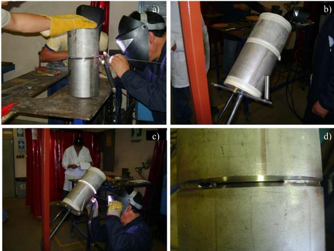
**Figura 22** Pasos del proceso de soldadura: a) preparación del espaciado de raíz, b) preparación para el suministro de gas de respaldo, c) soldadura en posición 6G y d) pasada de raíz.
