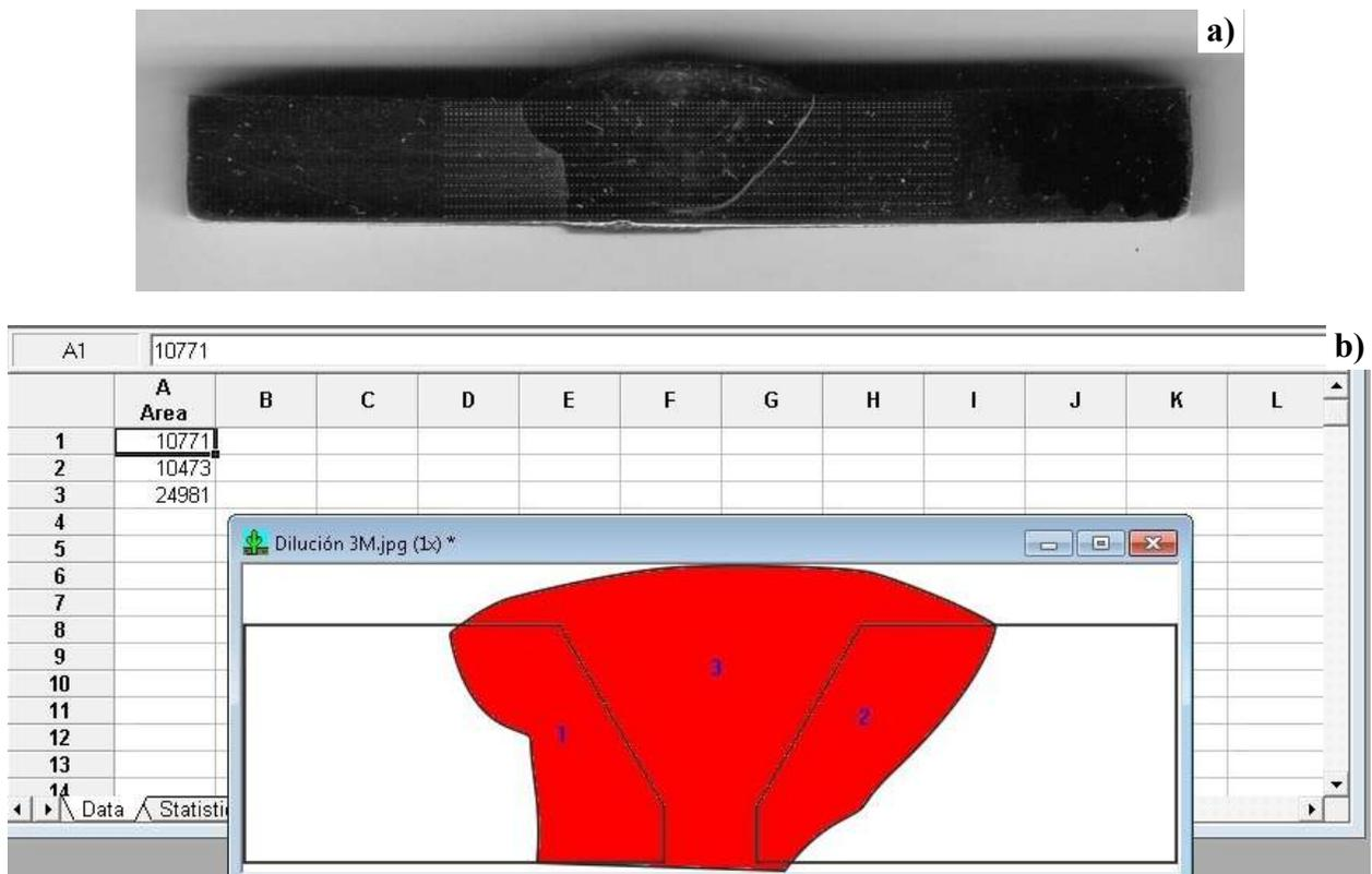
**Figura 53** Mediciones de dilución obtenidas mediante software para la soldadura de alto aporte térmico
