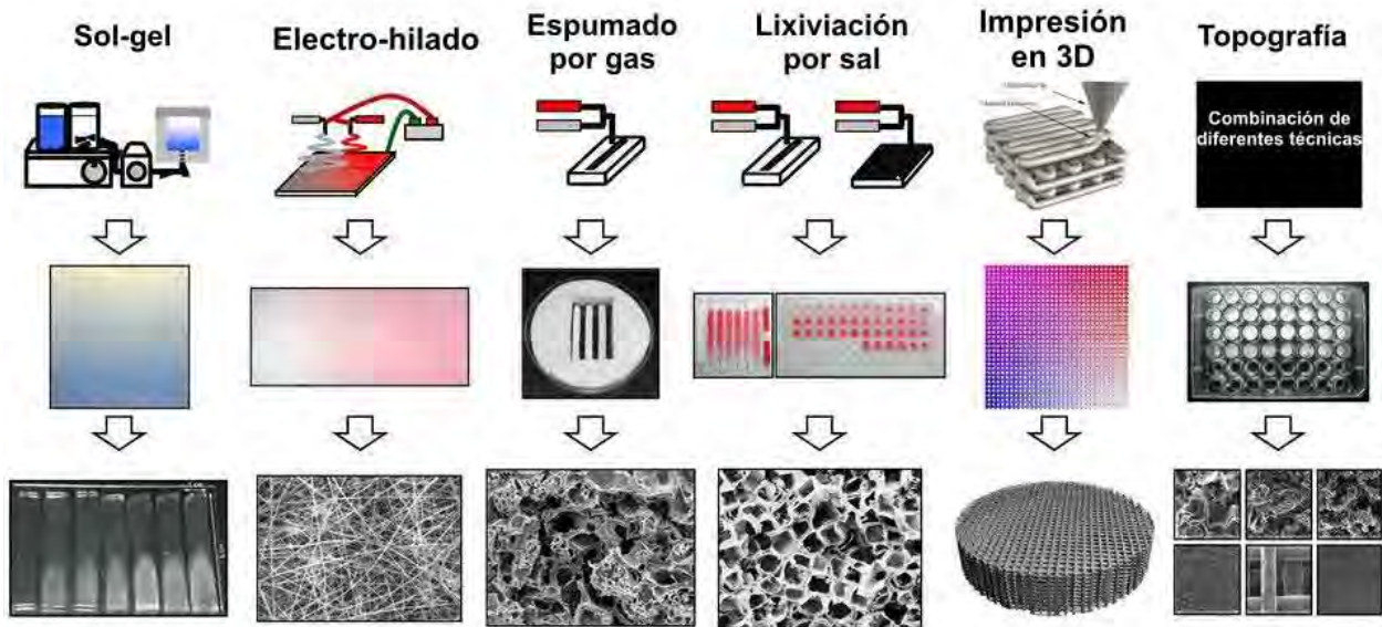
Figura 2.9 Métodos de fabricación de andamios para ingeniería de tejido óseo [54].
