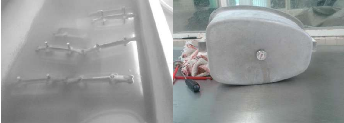
Fig. 19 y 20. Moldes con la pasta en cocción y verificando el cocimiento mediante el termómetro eléctrico de aguja.
