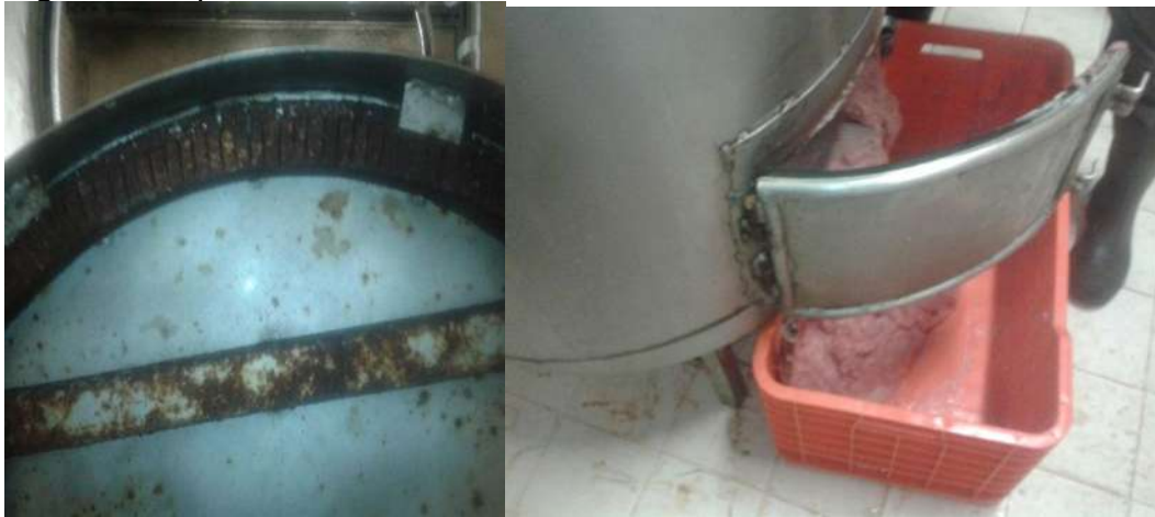
Fig.15 y 16. Parte exterior y posterior corroída de la Masajeadora y obtención de la pasta.
