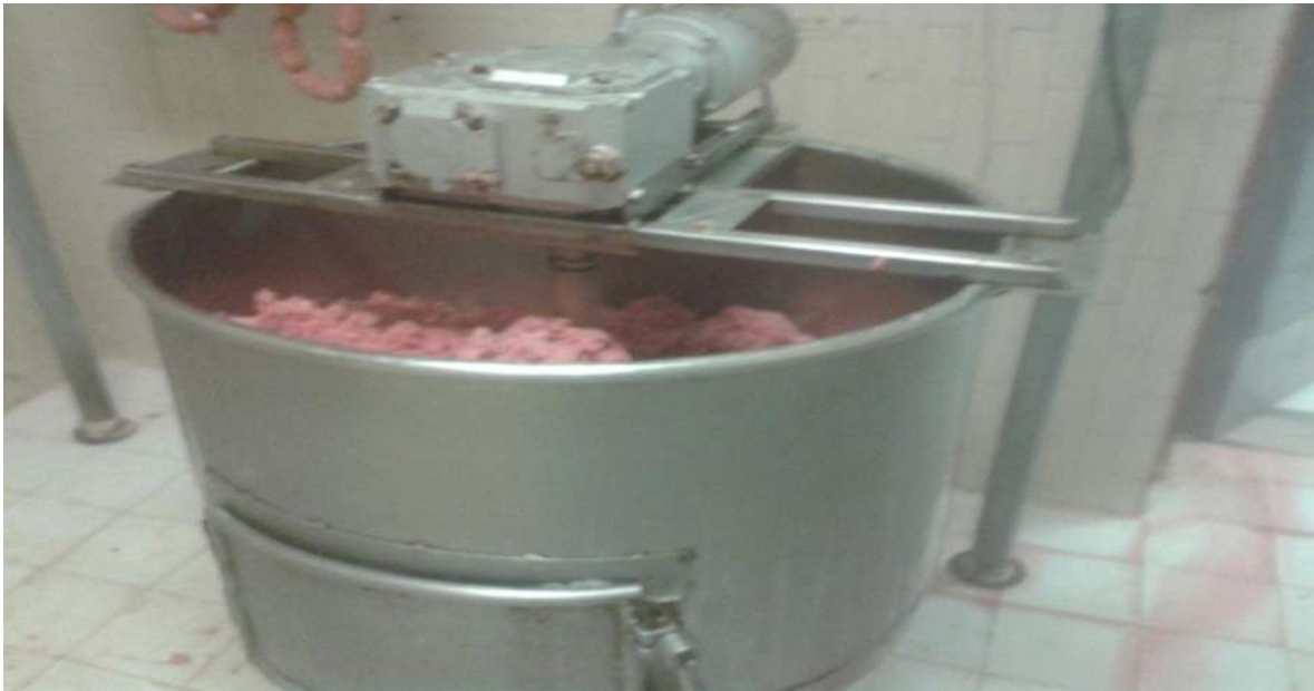
Fig. 14. Masajeadora de la carne y salmuera para el jamón de cerdo.
