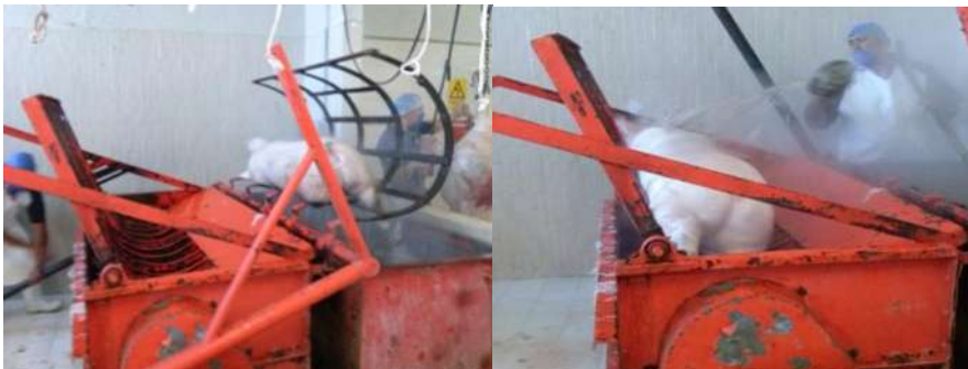
Fig.62 Para el escaldado solo se mete un animal a la vez para posteriormente pasarla al depilado.
