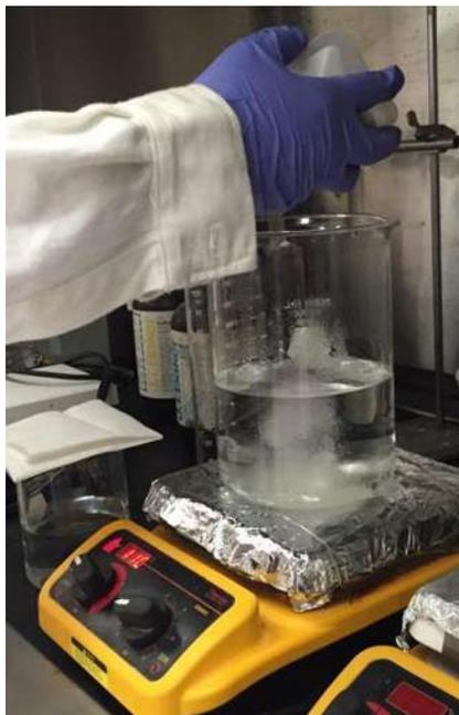
**Figura 2.2.** Se muestra la preparación de la solución por el método Pechini.
