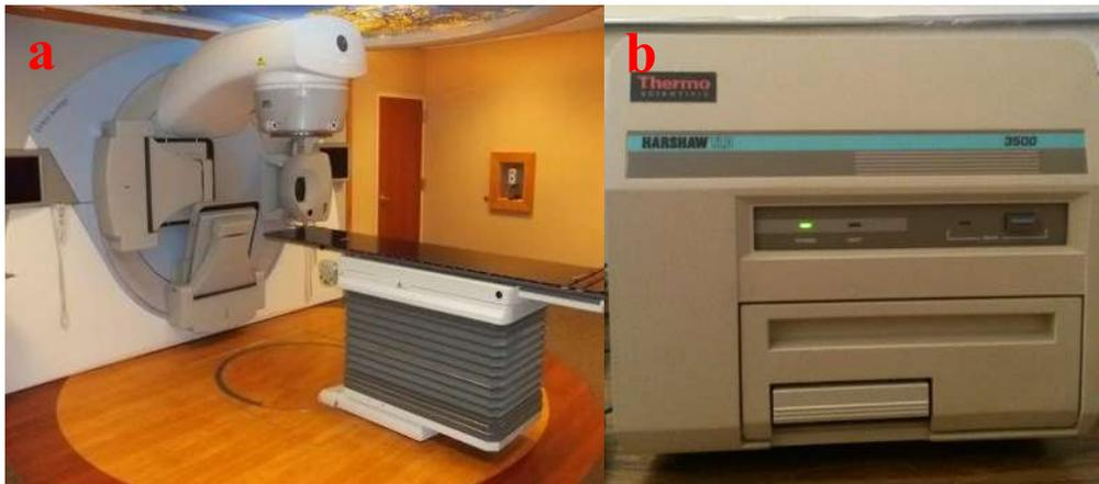
**Figura 2.10.** Acelerador lineal de Elekta Synergy (a) y Equipo lector TL3500 (b).
