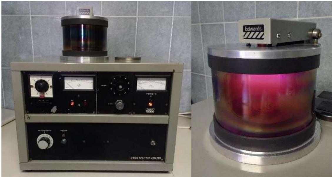
**Figura 2.7.** Metalizadora de cobre.
