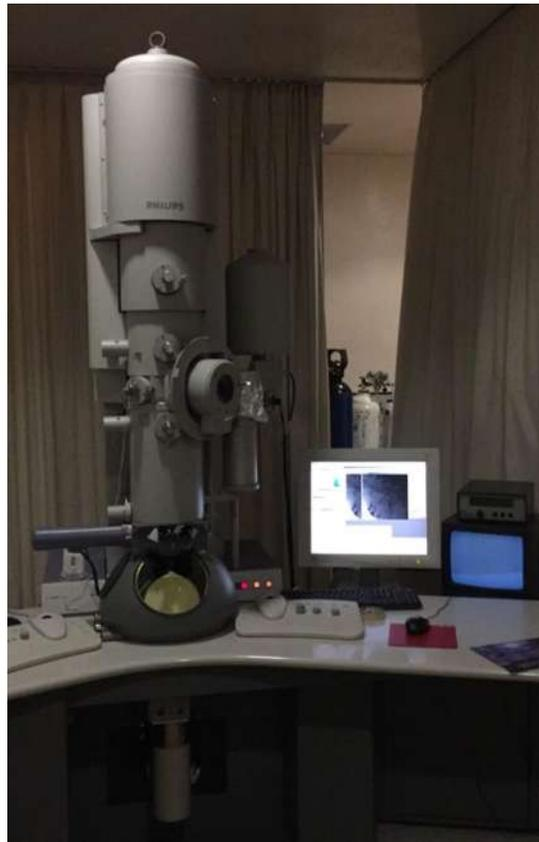
**Figura 2.9.** Microscopio Electrónico de Transmisión Philips Tecnai F20.
