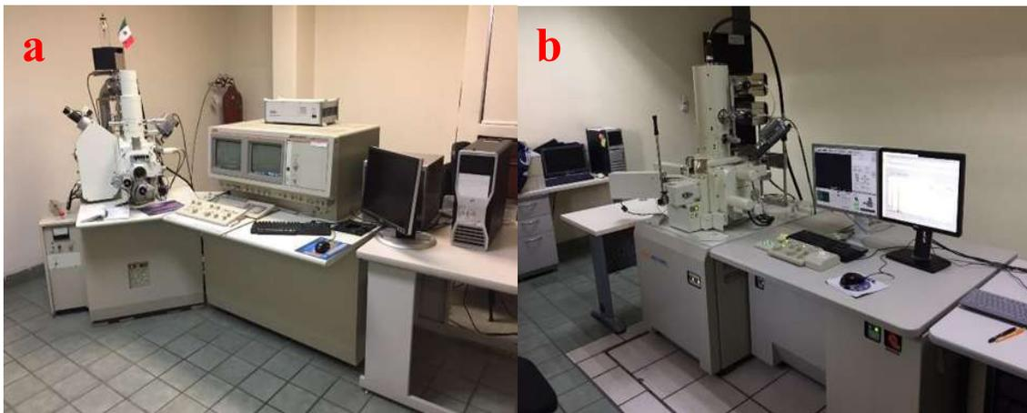
**Figura 2.8.** Microscopio JEOL JSM-6400 (a) y microscopio de emisión de campo JEOL JSM-7600F (b).
