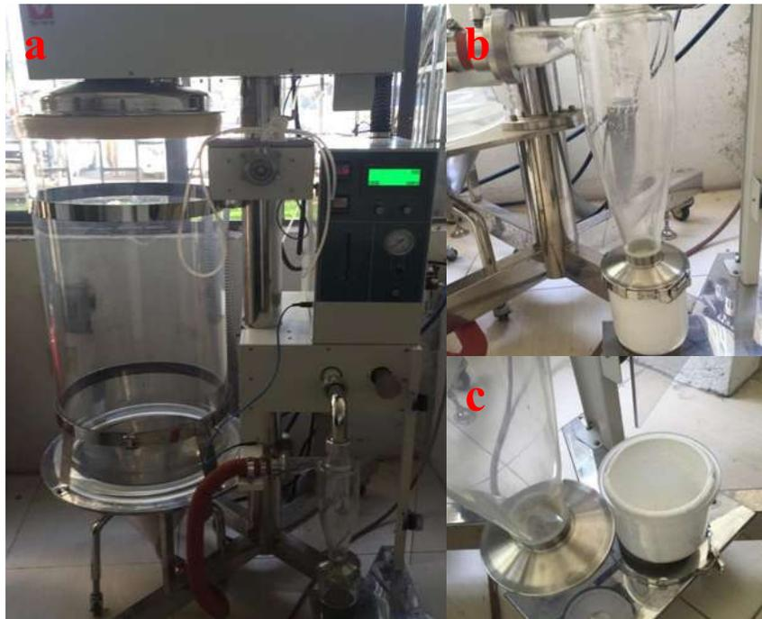
**Figura 2.3.** En la imagen se muestra el equipo de secado Spray Dryer en (a), ciclón en la imagen (b) y el recipiente donde se captura el polvo en (c).
