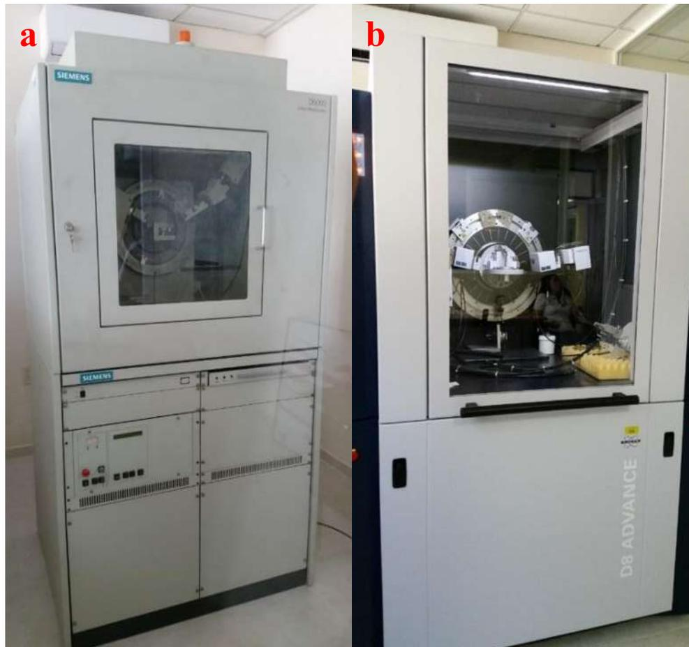
**Figura 2.6.** Difractómetro Siemens D5000 (a) y Bruker D8 Advance (b).
