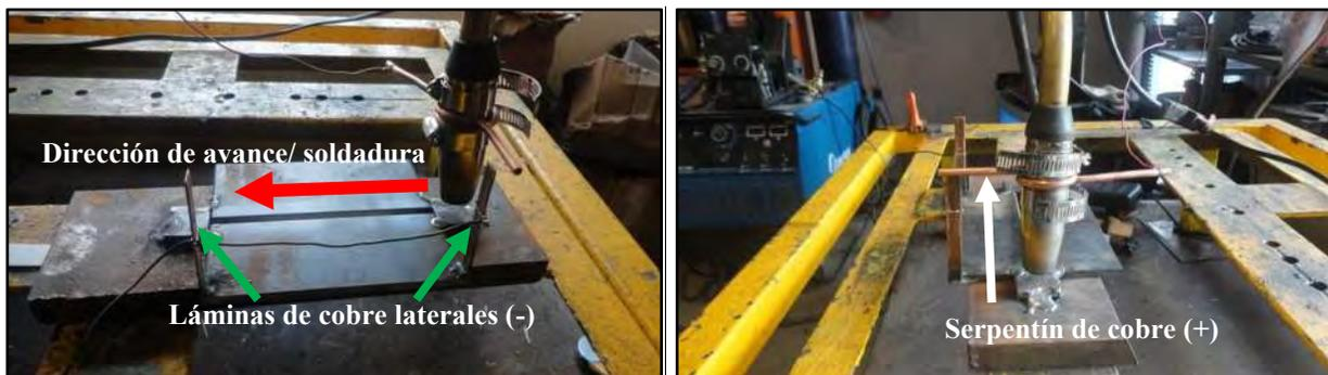
**Figura 3.10.** Arreglo del dispositivo para inicio y fin de mediciones de sensores durante el arco eléctrico estable.
