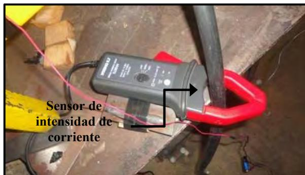
**Figura 3.8.** Ubicación de sensor de intensidad de corriente durante el proceso de soldadura.
