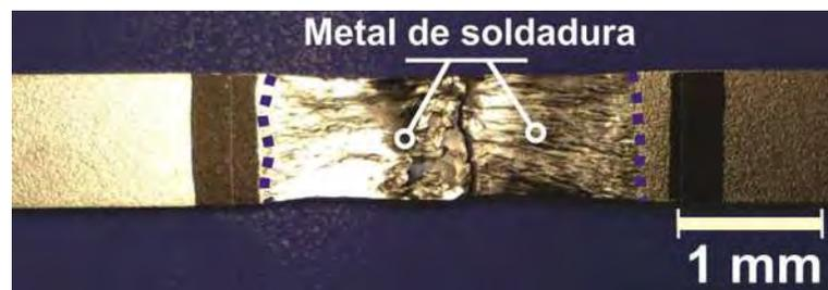
**Figura 4.44.** Imagen de vista superior correspondiente a la fractura posterior al ensayo de tracción de probeta en condición de soldadura sin IEMBI.
