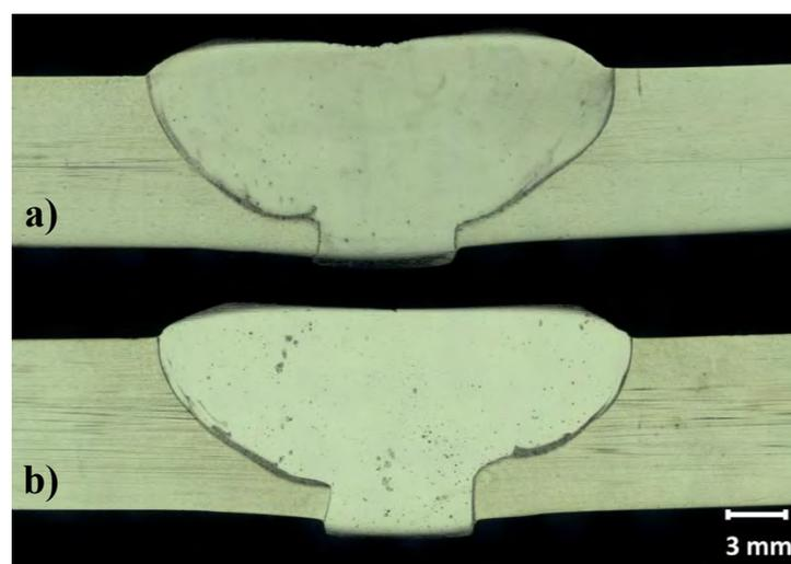
**Figura 4.27.** Perfiles de la sección transversal al cordón de soldadura para ambas condiciones de soldadura: a) 0mT y b) 3mT.
