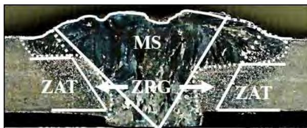
**Figura 3.11.** Secciones consideradas para el análisis electroquímico; ZAT, ZRG y MS.
