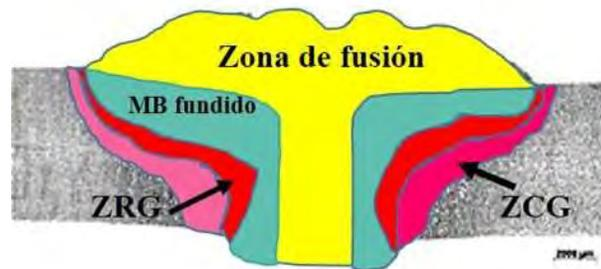
Figura 3.5. Perfil transversal de una soldadura indicando las áreas medidas.
