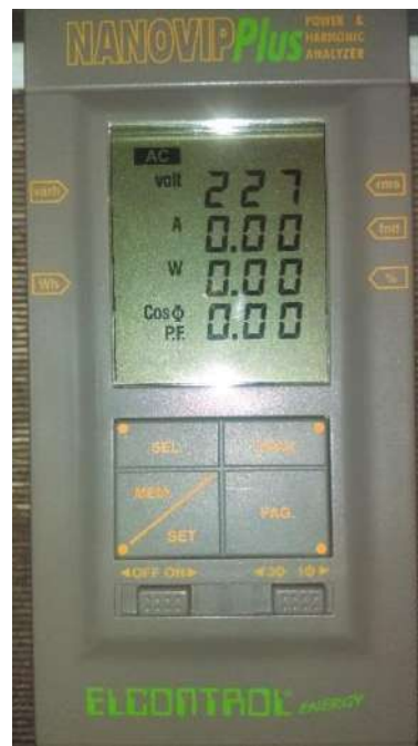
Figura 3.3 Analizador de armónicos empleado para medir la potencia.
