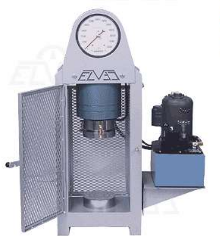
Figura 3.8. Prensa hidráulica Marca ELVEC, utilizada para prueba de compresión de cubos.
