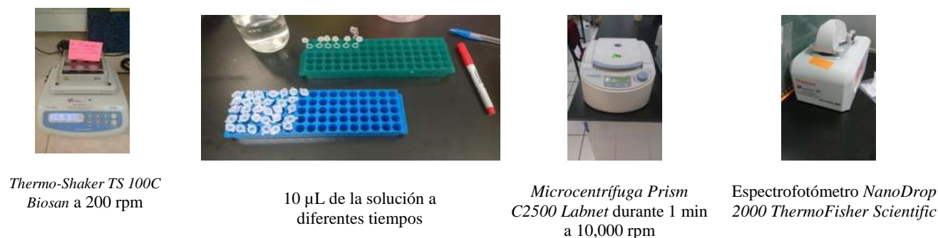
Figura 3. 14 Procedimiento para medir la cinética de liberación del fármaco en los andamios cargados con microesferas.
