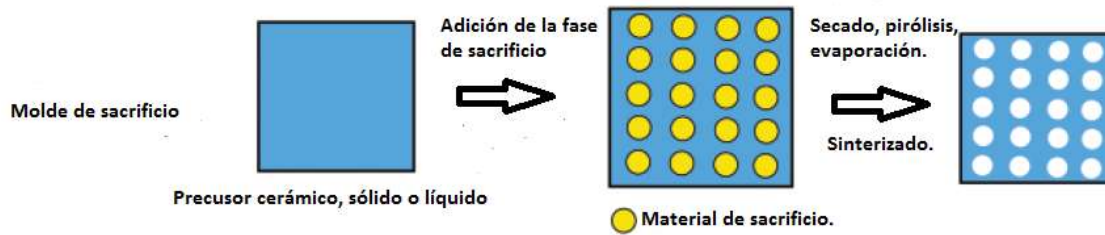
Figura 2. 12 Método del molde de sacrificio [54].
