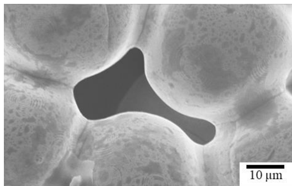
Figura 2.19. Imagen electrónica por barrido de los bordes de sinterización que se forman entre las partículas esféricas originalmente en el punto de contacto [56].
