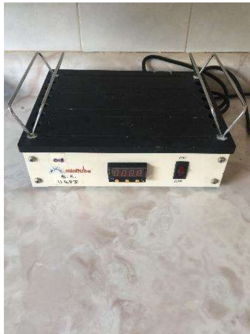
Figura 22. Platina térmica para atemperar portaobjetos, cubreobjetos y pipetas Pasteur.
