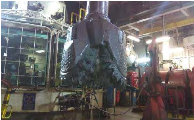
Herramienta de perforación para la industria petrolera con puntas de carburo de tungsteno
