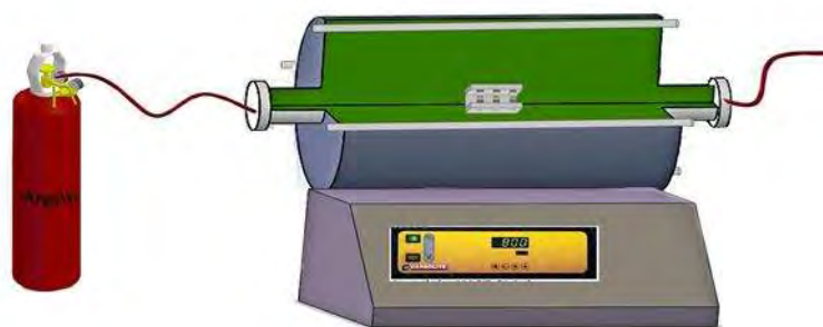
Figura 3.7 Esquema representativo del horno horizontal utilizado para producir uniones.
