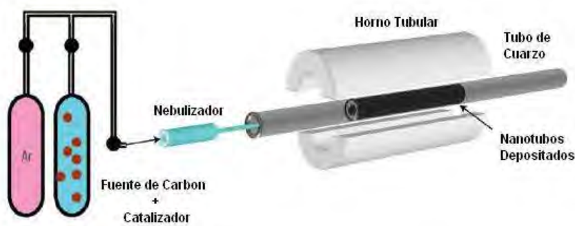
Figura 2.11 Esquema representativo del método de Spray-Pirólisis para la síntesis de NTC [43].
