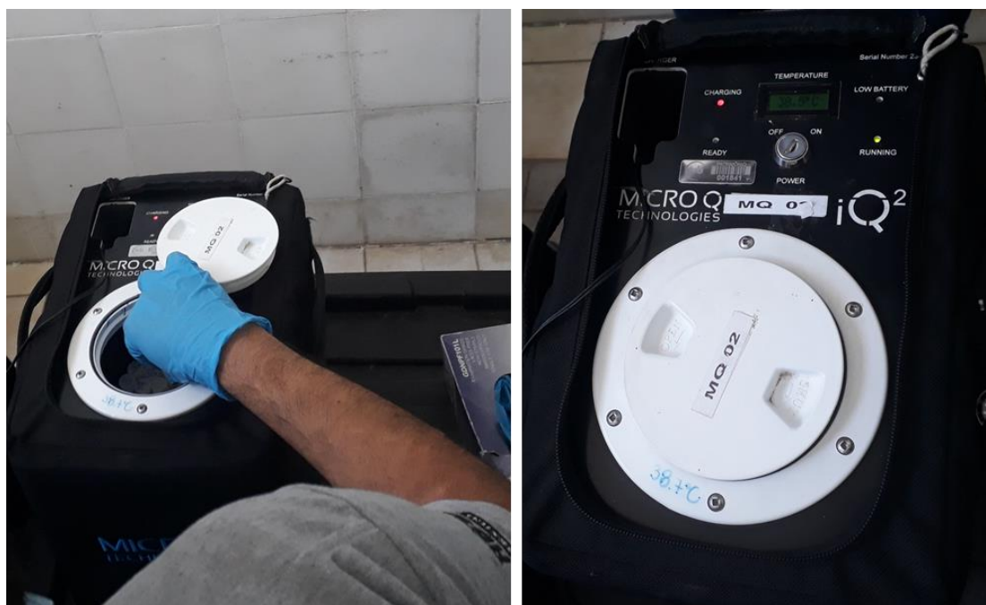
Figura 44. Colocación de los tubos en la transportadora MICRO-Q 22.
