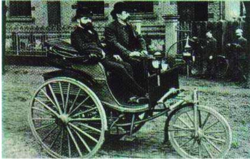
Imagen 1.1: Triciclo Benz 1885, impulsado por un motor de combustión interna, ciclo Otto. Carl Benz en la foto. Foto en: Asimov, Isaac, “Enciclopedia Biográfica de Ciencia Y tecnología” , México, Alianza, 1989, P. 328
