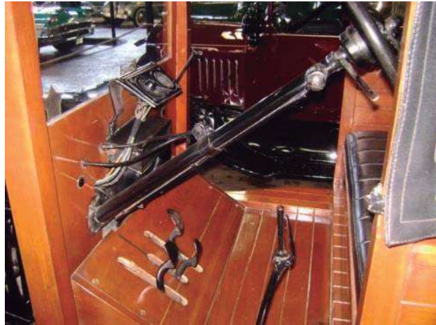
Imagen 1.7: Fotografía del interior de un Ford T de 1914, donde se muestran la ubicación de los mecanismos para controlar al automóvil. Tomada en el Museo del Automóvil de la Cd. de México
