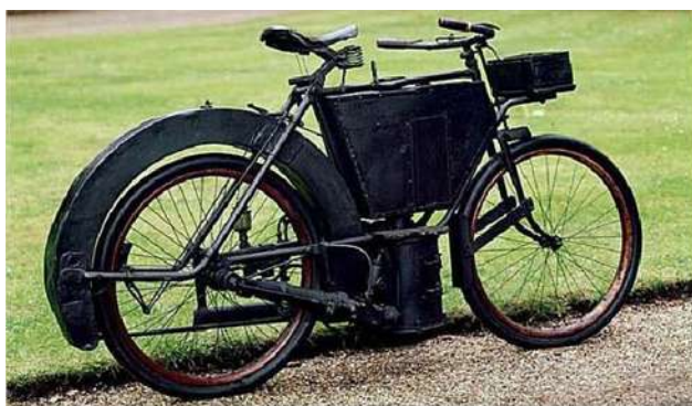
Versión de 1889, con bastidor cerrado y una primitiva suspensión delantera 59
