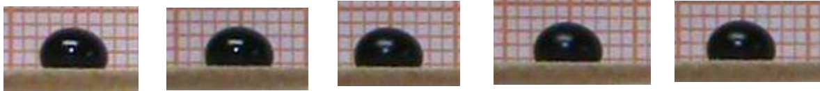
Figura 15. Avance del ángulo de contacto de la formulación adhesiva3= 50% lignina -fenol-formaldehído sobre una superficie de madera
