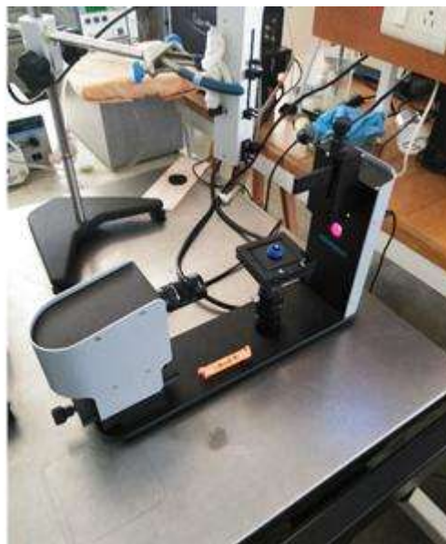
Figura 12. Equipo goniómetro attention theta cam 2008
