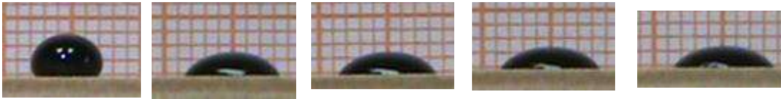
Figura 13. Avance del ángulo de contacto de la formulación adhesiva 1= 30% lignina -fenol-formaldehído sobre una superficie de madera
