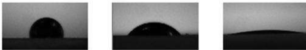
a) Mojado deficiente
