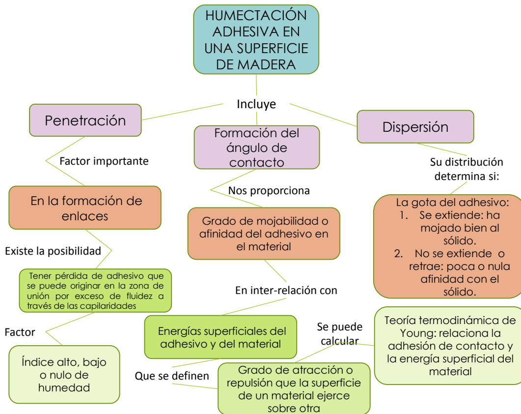
Diagrama 2. Proceso de humectación adhesiva en una superficie de madera. (Adaptado)
