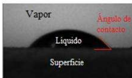
Figura 5. Formación del ángulo de contacto en la interacción líquido-sólido-vapor
