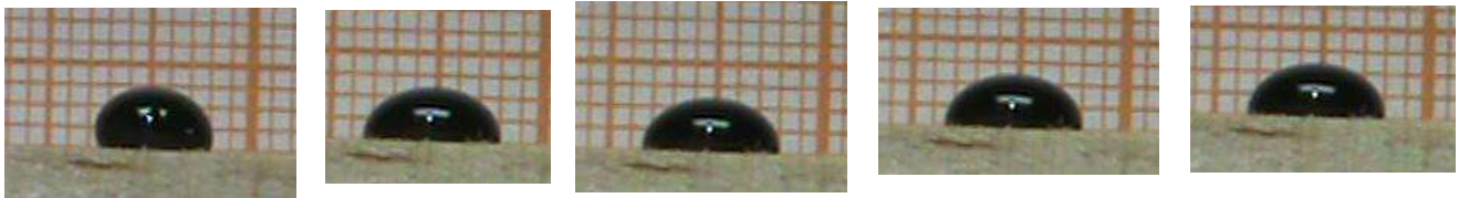
Figura 16. Avance del ángulo de contacto de la formulación adhesiva 4=60% lignina-fenol-formaldehído
