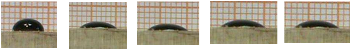
Figura 14. Avance del ángulo de contacto de la formulación adhesiva2= 40% lignina-fenol-formaldehído sobre una superficie de madera
