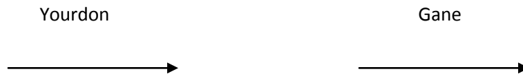
Fig. 5 Flujo de datos. Se utiliza para realizar movimientos de datos en determinada dirección.
