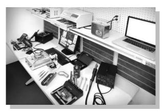
estación, soportes para tarjetas, fuente conmutada de corriente directa, multímetro, lentes protectores, guantes antiestáticos, cargadores de diferentes entradas, televisión (para los videojuegos) y algunas herramientas para intervenir los equipos.
