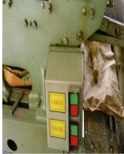
Con esta parte de la maquina se le da las diferentes formas a la tortilla y se ajusta para cuando se tiene pedidos de tortilla ovalada especial para la venta de tacos o en su defecto para fabricar la tortilla normal redonda, de igual forma se utiliza para darle forma en cuestion de que si se quiere fabricar tortilla gruesa o delgada.
