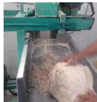
El siguiente paso, es extraer la masa del molino para pasarla a otro espacio conocido como el área de reposo en donde permanece la masa hasta que es requerida para depositarla en la batidora.
