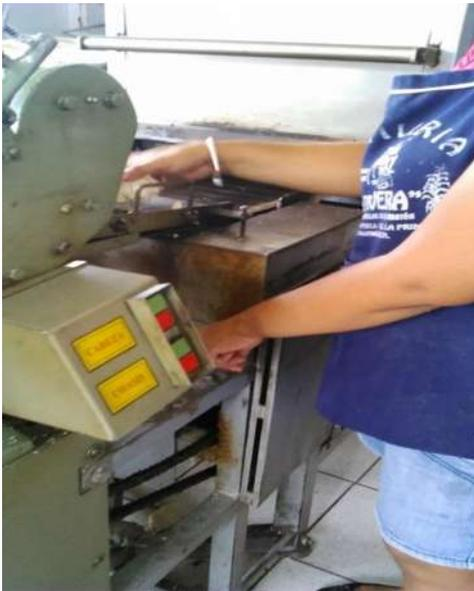
**Encendido del gas electrónicamente en maquinaria de modelo reciente**
