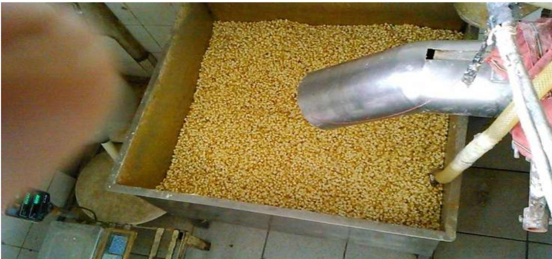
Posteriormente, se hace el vaciado del nixtamal al molino utilizando una cubeta para llenar el cono que conducirá el grano a las piedras que son la parte que se encarga de triturarlo para convertirlo en masa.
