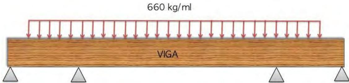
Figura 74. Viga uniformemente carga y cuatro apoyos. Elaboró: Ramón Holguín.
