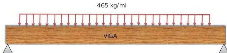
Figura 97. Viga uniformemente carga y simplemente apoyada. Elaboró: Ramón Holguín.
