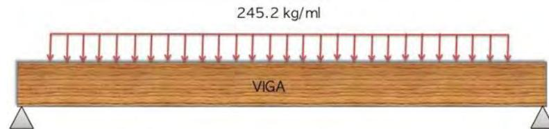
Figura 36. Viga uniformemente cargada. Elaboró: Ramón Holguín.
