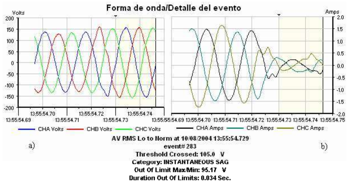
Figura 3.53 Forma de onda y detalle del primer sag en el archivo PCS 35; a) Voltaje, b) Corriente
