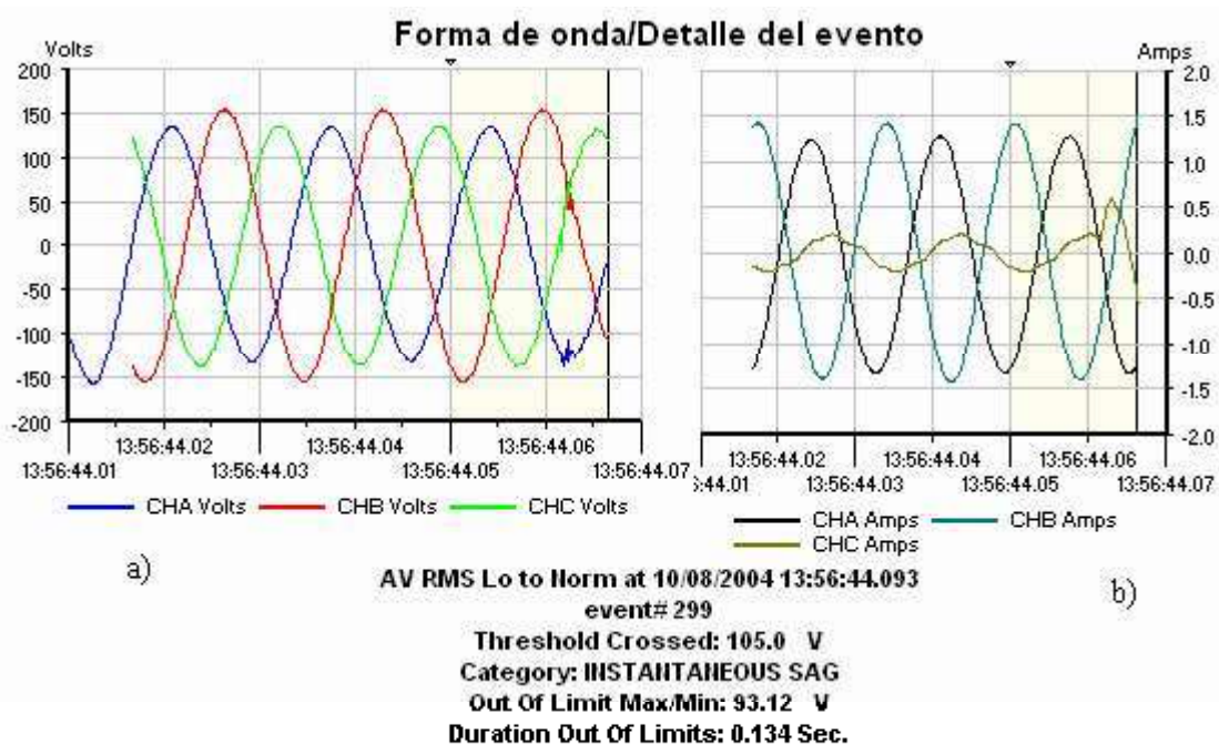
Figura 3.54 Gráficas y detalle del segundo sag presentado en el archivo PCS 35; a) gráfica de voltaje, b) grafica de corriente.
