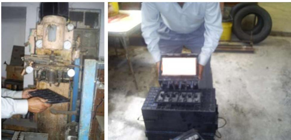
Figura 5.9 Sellado de la batería.
