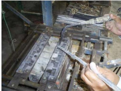
Figura 5.7 Soldado de los conectores y postes de la batería
