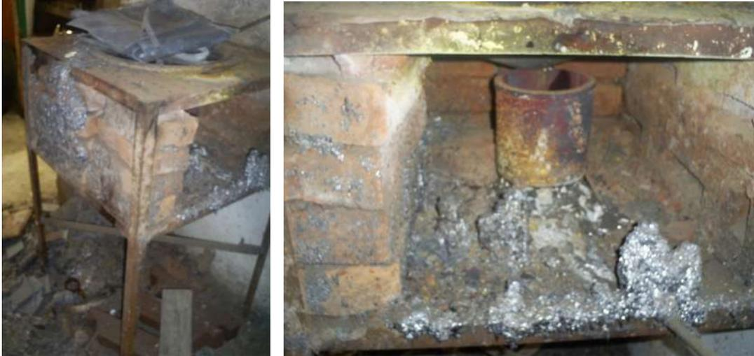
Figura 5.3 Horno para la fundición de Pb
