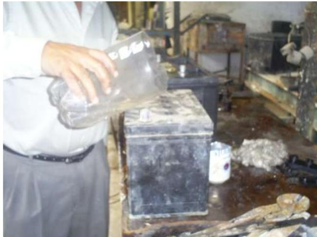
Figura 5.10 Vaciado de ácido sulfúrico.
