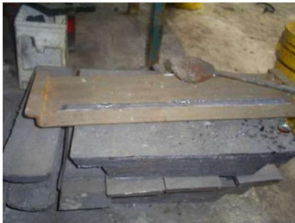
Figura 5.4 Moldes para la elaboración de las barras de Pb
