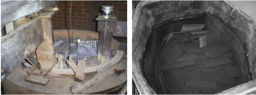
Figura 5.16 Maquinaria para la fabricación de placas positivas y negativas.
