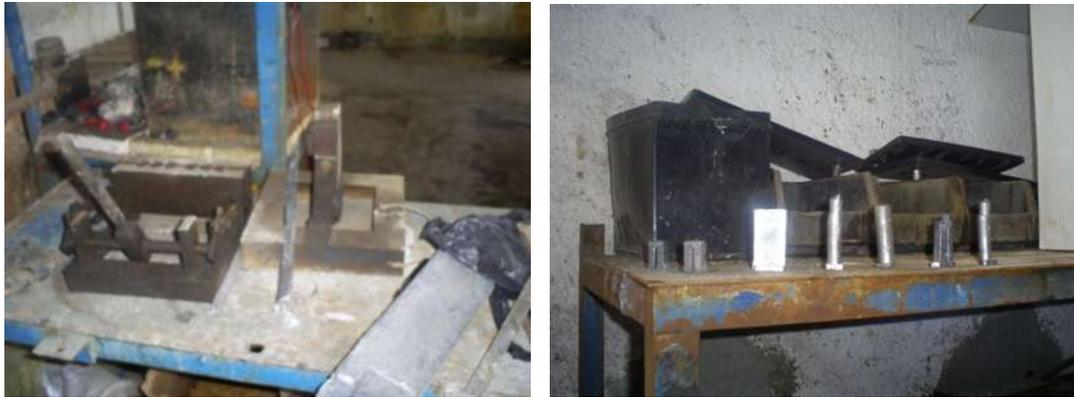
Figura 5.5 Moldes y el producto terminado de conectores y postes
