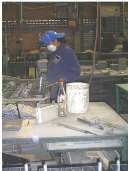
Figura 5.17 Fundición de Pb para el soldado de los conectores y postes de las placas.
