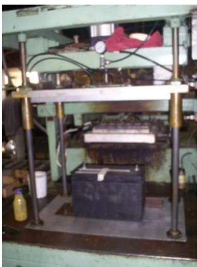
Figura 5.18 Maquinaria para el sellado de la batería.
