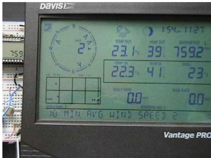
Figura 5.15 Comparación de la presión con el medidor calibrado.
