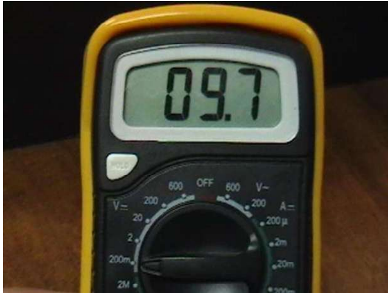
Figura 5.2 Medición de voltaje en terminales del MPXM2102.
