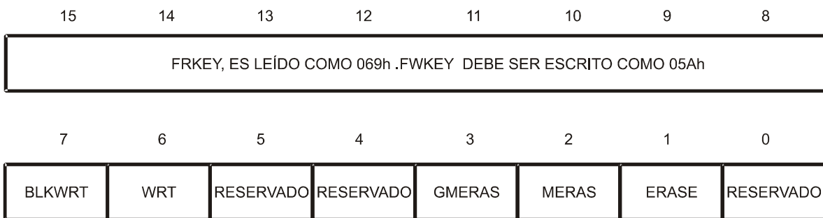
Figura 4.28 Estructura del registro FCTL1.
