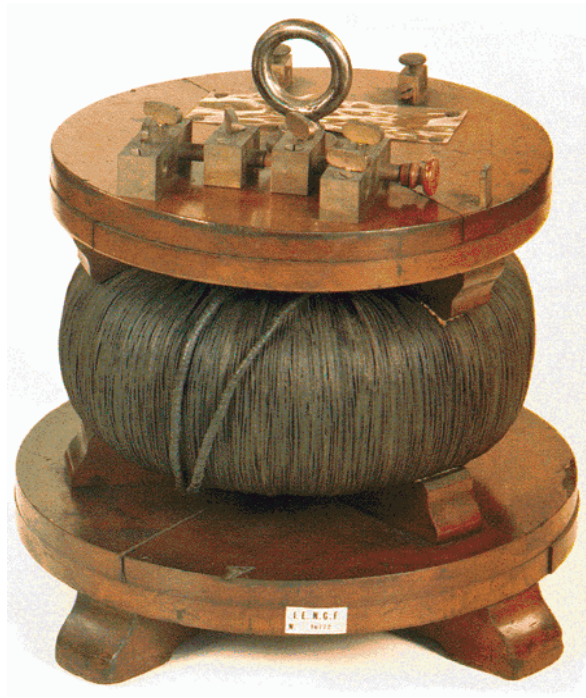
Figura 2.7 Transformador de la compañía húngara Ganz [Galván et al. 2006]
