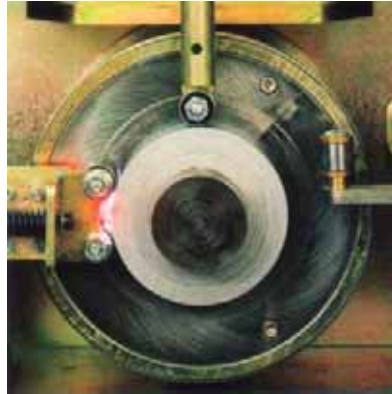
Figura 2.22 Máquina para enrollar lámina continua [Cortech Machines 2006]
