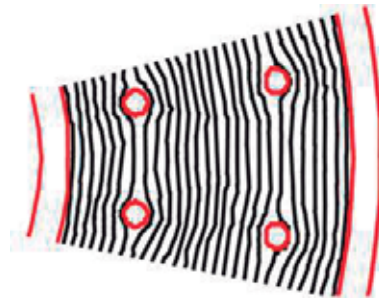
Figura 4.16 Flujo magnético rodeando los agujeros
