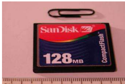
Figura 2.5 Tarjeta de memoria FLASH tipo CompactFlash
