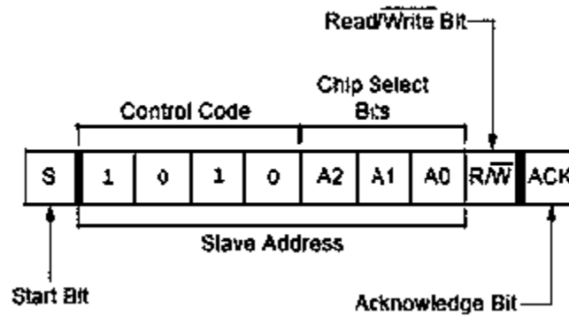
Figura 3. 9 Descripción de los bits del byte de control.
