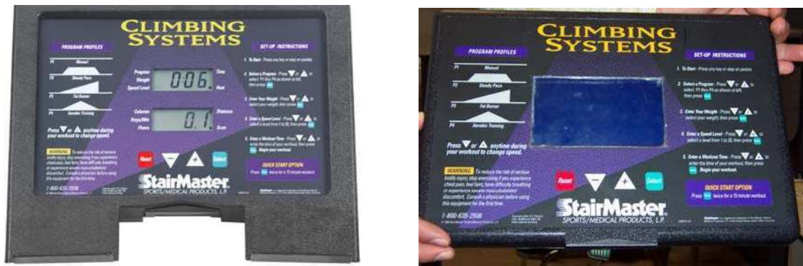
Figura 3. 64 Pantalla original y colocación de la pantalla gráfica en el tablero.
