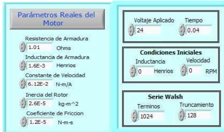
Figura 3.9 Interfaz para la captura parámetros reales del Motor de CD.
