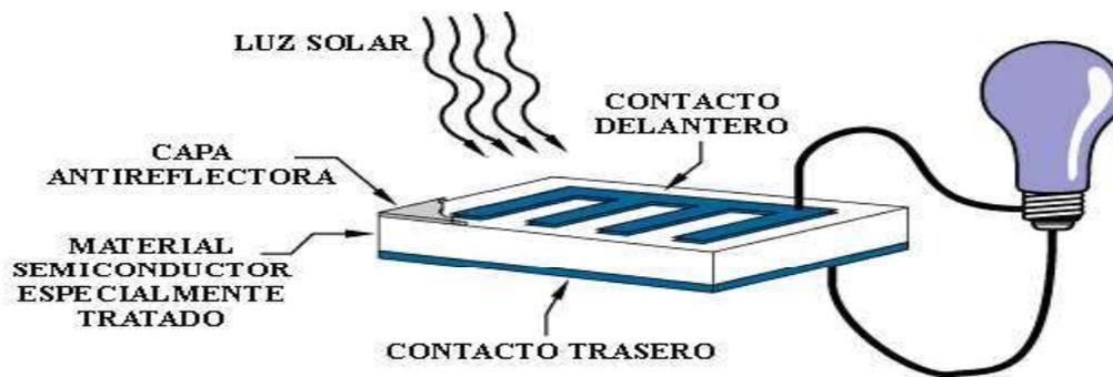
Figura 2.1 Operación de una celda fotovoltaica
