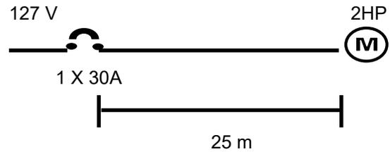
**Fig. 2.10.1** circuito derivado de un motor
