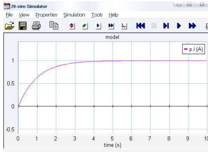
Figura 4.8 Respuesta en el dominio del tiempo de un sistema eléctrico RL en serie.
