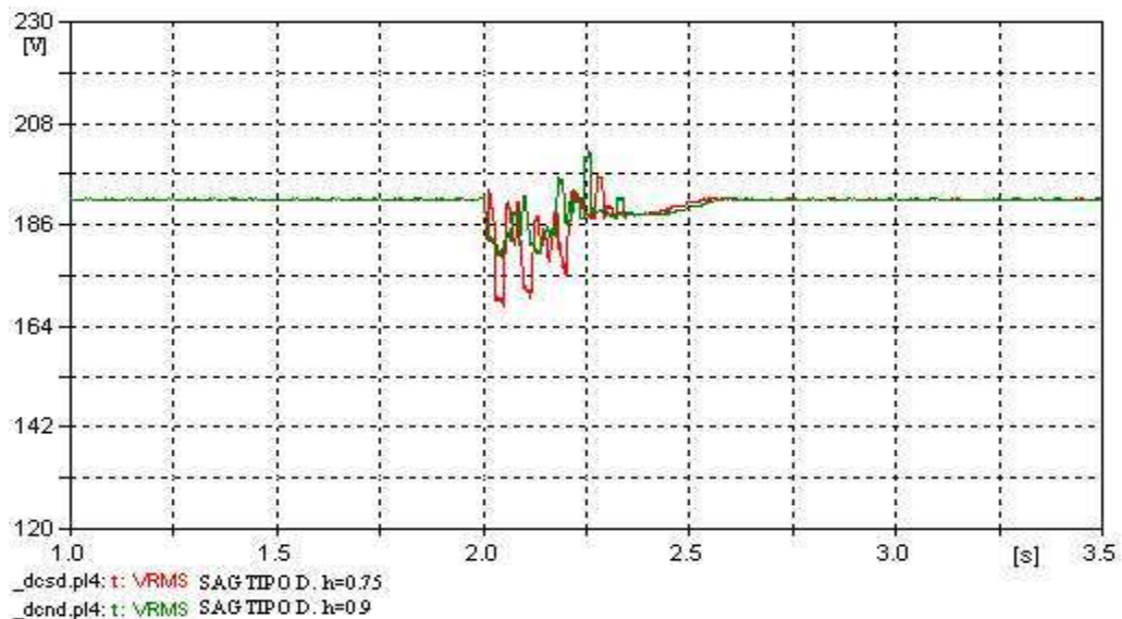
Figura 4.41. Voltaje rms en el enlace de CD bajo una depresión de voltaje tipo D, \Delta t = 12 ciclos y diferente profundidad.
