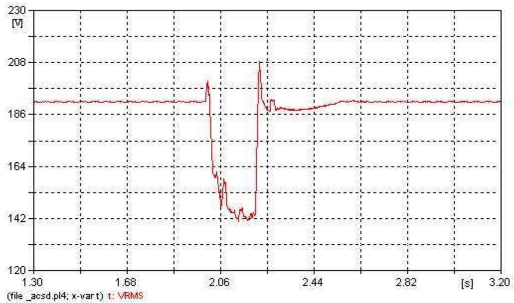
Figura 4.31. Voltaje rms en el enlace de CD.
