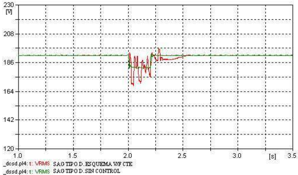
Figura 4.37. Voltaje rms en el enlace de CD bajo una depresión de voltaje tipo D, h = 0.75 y \Delta t = 12 ciclos.
