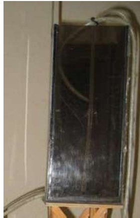
Figura 2.1 Tanque contenedor de acrílico semitransparente sentado en una base de madera
