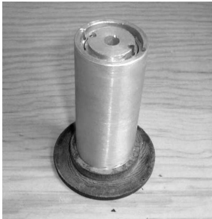
**Figura 3.7** Fotografía de los dos cilindros concéntricos ensamblados en la tapa inferior
