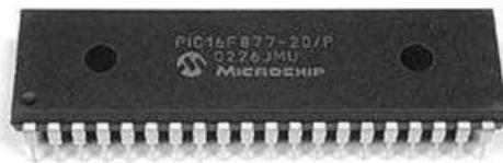
**Figura 3.10** Microcontrolador PIC16F877A
