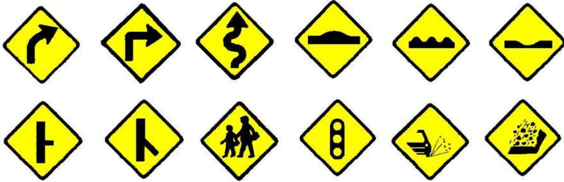
Figura 3.1 señales de prevención de vías de tránsito
