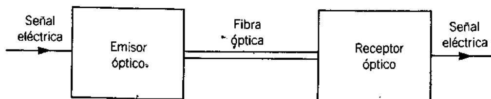
Figura 2.32 Sistema de comunicación por fibra óptica
