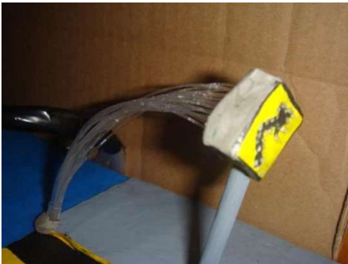
Figura 4.18 Señal para dar vuelta. Del lado izquierdo se puede observar van algunas fibras en la señal y a la derecha se puede ver las señal iluminada con las fibras ópticas.
