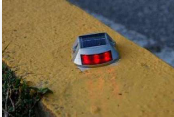
Figura 3.9 Un tipo de Vialita de la carretera utilizando leds.
