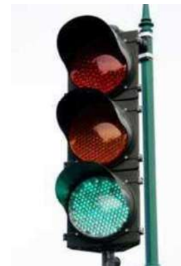
Figura 3.4 Semáforo común con la utilización de leds.
