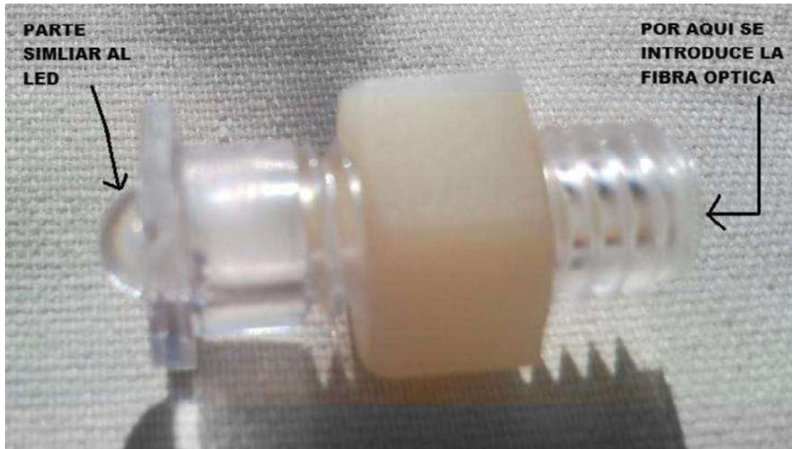
Figura 4.9 Molde para sustituir a los leds por la parte de la fibra óptica. Tiene la punta similar a un led solo que en la parte de atrás se podrá introducir las fibras ópticas.
