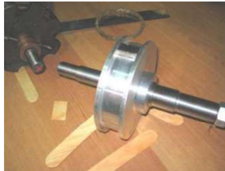
Figura 5.16 Muestra el trazo de inicio para el pegado de los imanes.
