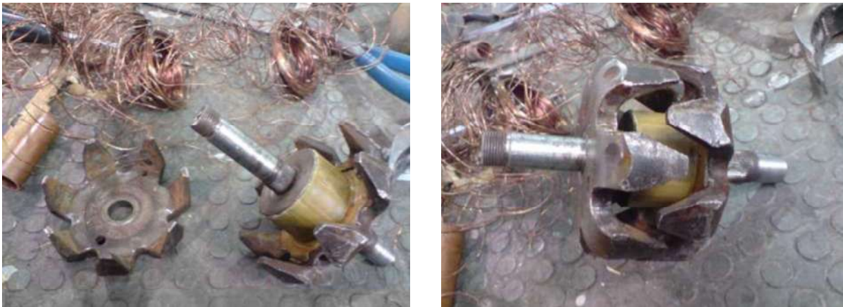
Figura 5.5 Desarme y limpieza del alternador de 12 volts.
