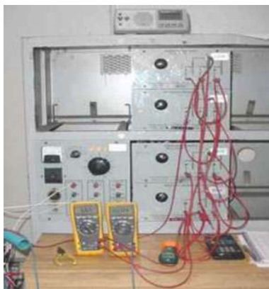
Figura 6.3 Instalación de los módulos de resistencias para hacer las pruebas con cargas resistivas.
