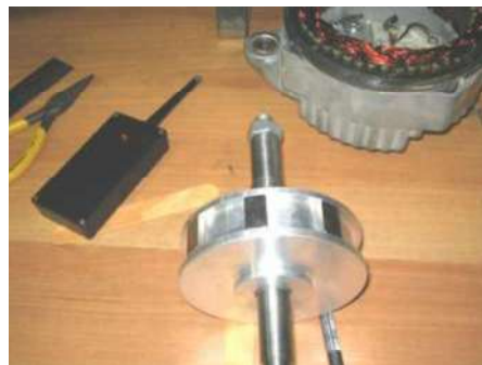
Figura 5.17 Muestra el procedimiento utilizado para el pegado de los imanes en el bloque del rotor.
