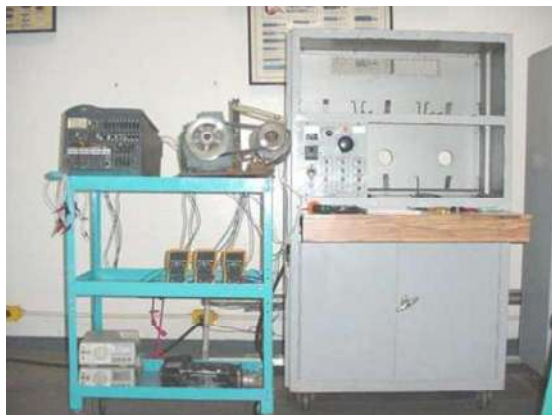
Figura 6.2 Muestra la conexión implementada para obtener las mediciones de las pruebas en vacío y de corto circuito.
