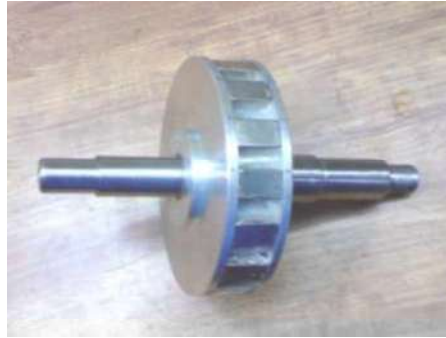
Figura 5.18 Finalización del rotor construido con 16 imanes de neodimio tipo bloque.
