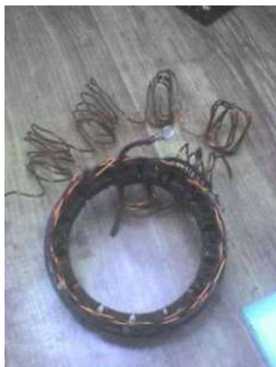
Figura 5.9 Muestra la eliminación de las bobinas.
