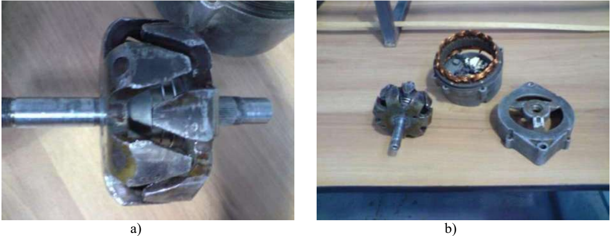
Figura 5.7 Se reemplazó la bobina de campo por imanes de neodimio tipo anillo, se optó por el imán de tipo anillo porque se tiene los dedos polares representando los polos.
