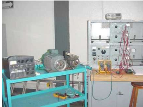
Figura 6.4 Conexión de los módulos de las resistencias con el prototipo del generador.
