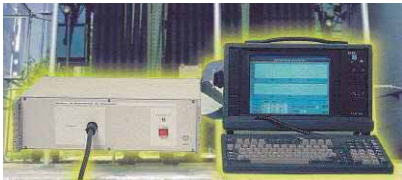
Figura 4.8 Medidor de impedancia de dispersión ETP-4
