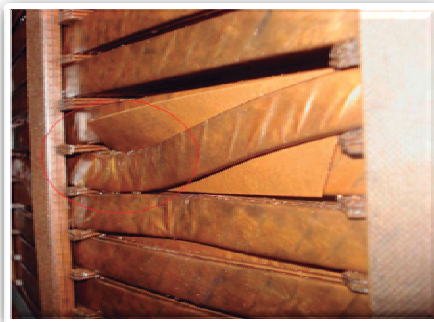
Figura 3.2 Deformación entre vueltas en un devanado.
