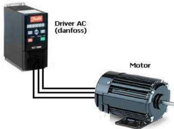
Figura 4.1 Motor asíncrono controlado por Driver VLT-2800.
