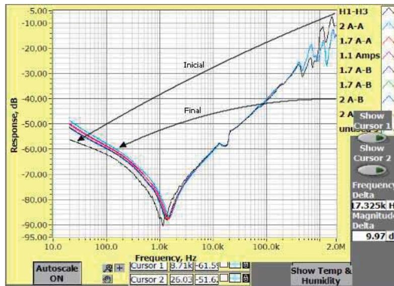
FIGURA 3.2: Respuesta debida a remanencia provocada a transformador en Laboratorio
