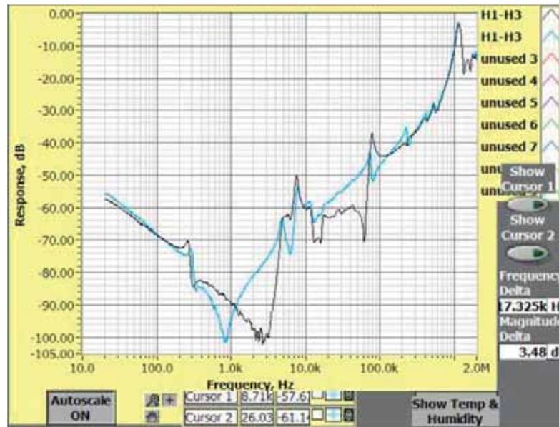
FIGURA 3.7: Respuesta Nulo aterrizamiento del núcleo
