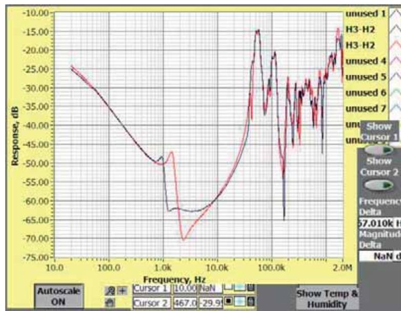
FIGURA 4.24: Transformador tipo horno con falla
