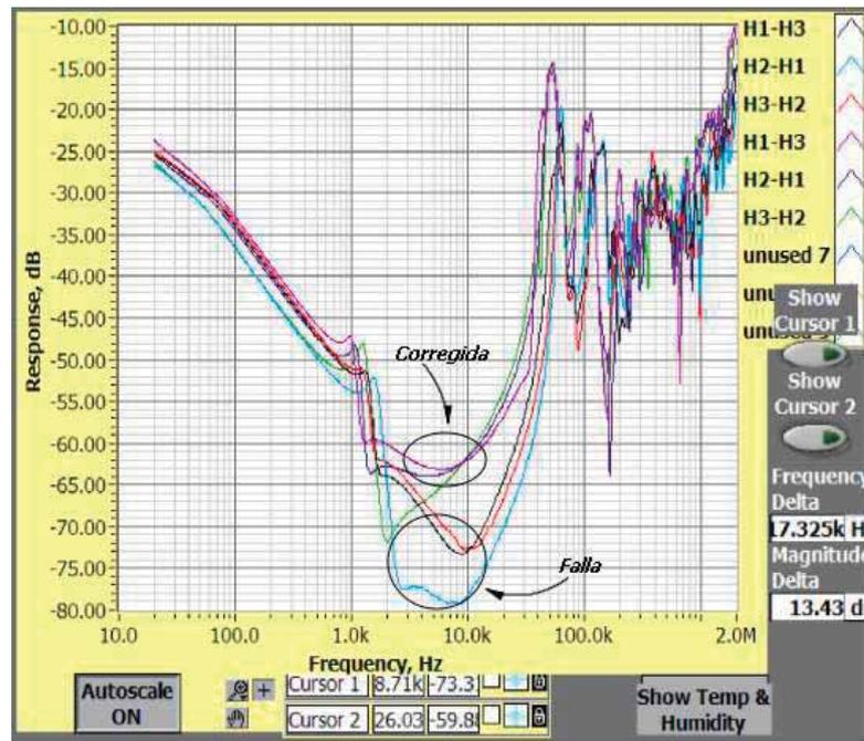
FIGURA 4.14: Respuesta a la corrección en la sujeción de los devanados
