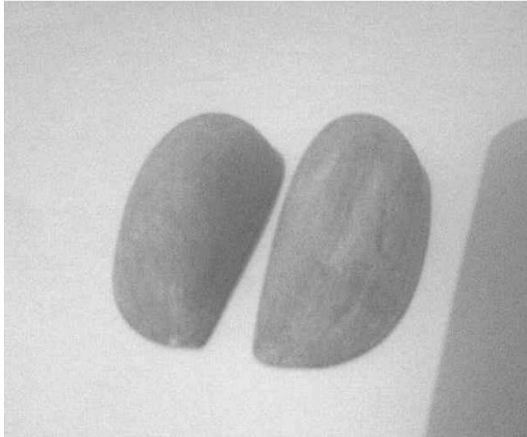
Figura 3.8 Modelos para la parte interior del álabe de la turbina Pelton.
