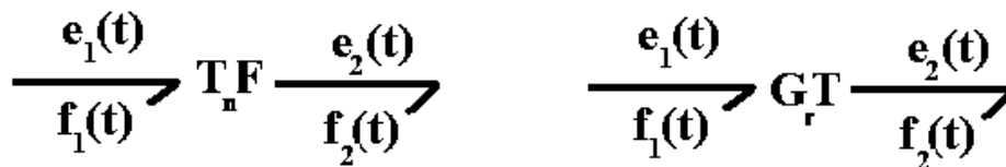
Figura 2.15 Representación en Bond Graph de un transformador (TF) y un girador (GY).
