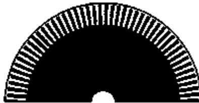
Figura 3.4 Disco interior de un encoder incremental
