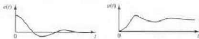
Figura 2.20 Gráficas de las curvas de e(t) y u(t) con señales de control distintas de cero cuando la señal de error es cero (control integral).
