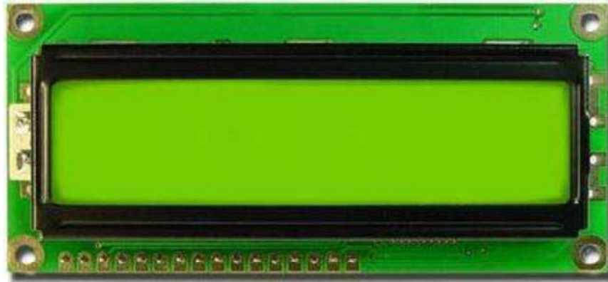
Figura 3.23 LCD compuesto por 2 líneas de 16 caracteres.
