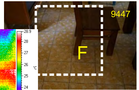
D IR01991.ISI 13 de Junio de 2013 04:07:14 p.m. Temperaturas imagen Térmica: Máxima: 29.49 / Mínima: 22.81 / Promedio: 22.95 Temperatura de la superficie: 20.4°C Temperatura del aire: 27.5°C Humedad relativa del aire: 40.3%HR
