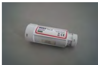
Figura 14 Hobo Datalogger U23-001
