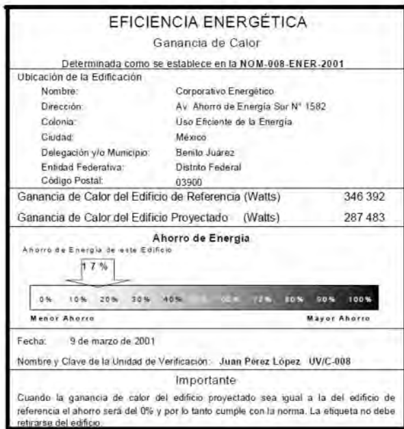
Figura 1. Ejemplo de Etiqueta que debe presentarse en un edificio que ha sido evaluado bajo la norma, Norma Oficial Mexicana NOM-008-2001, Eficiencia energética en edificaciones, envolventes de edificios no residenciales. 127
