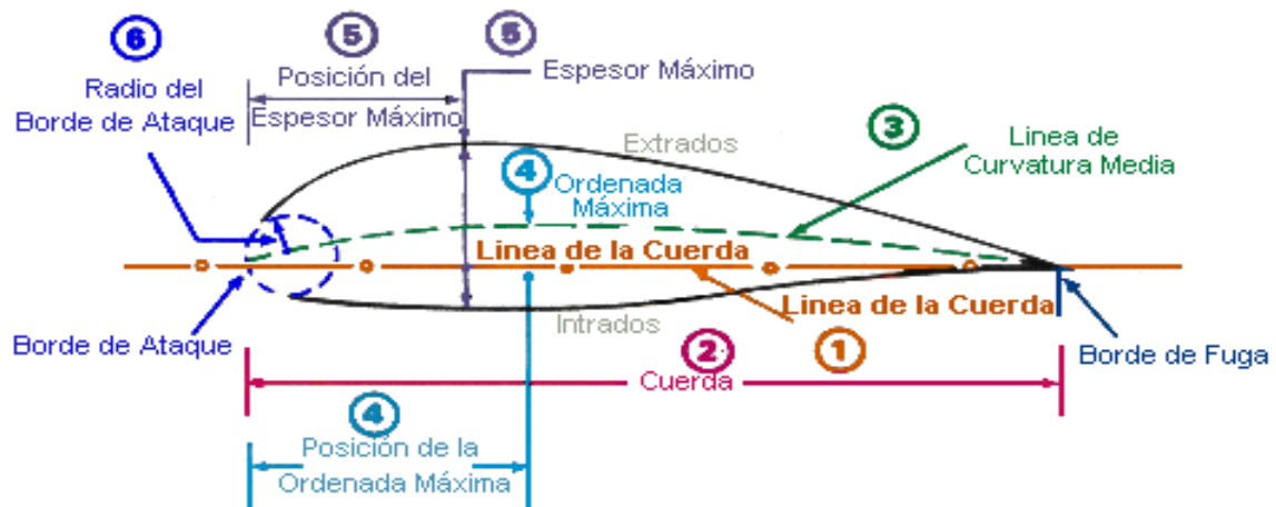
Figura 2.9. Terminología utilizada en un perfil.
