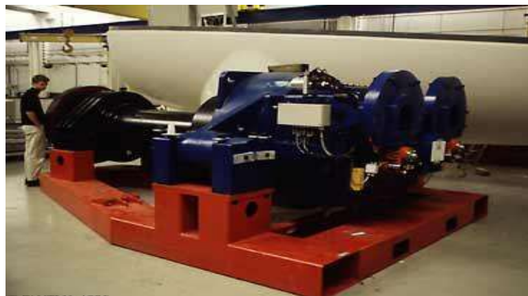
Figura 2.28. Caja multiplicadora. Copyright 1997-2003 Asociación danesa de la industria eólica Actualizado el 10 de mayo 2003
