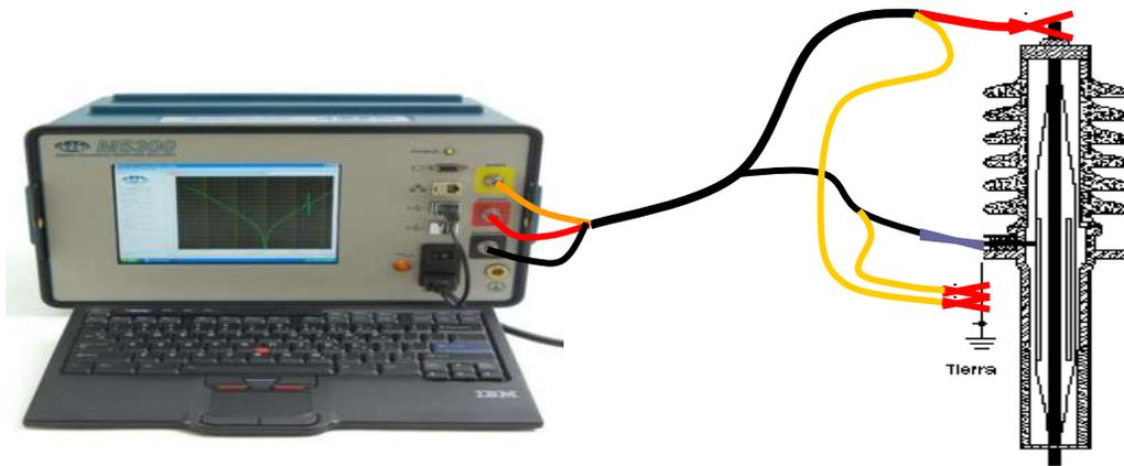
Figura 4.22 Conexión para medición de la respuesta a la frecuencia de boquillas.
