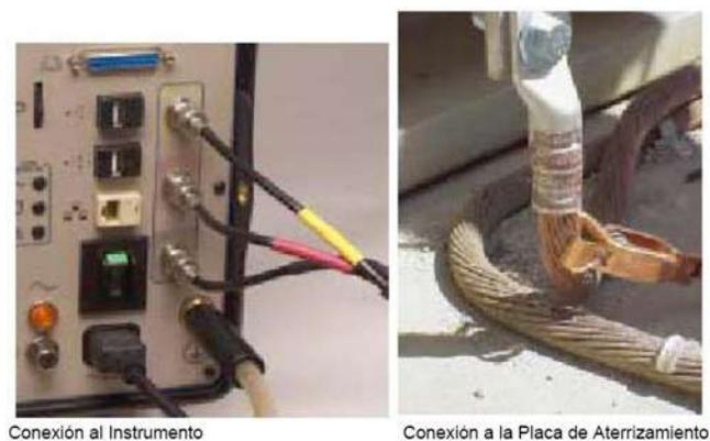
**Figura 4.9** Sistema de referencia a la red de tierra del equipo de prueba utilizado para la medición de RF.
