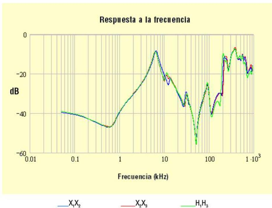
**Figura 4.5** Ejemplo de la aplicación del método impulsivo, para obtener la respuesta a la frecuencia a los devanados BT de un transformador trifásico.
