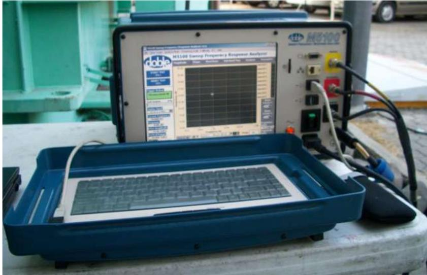
**Figura 4.7** Equipo de prueba utilizado para el barrido de respuesta a la frecuencia a los devanados de un transformador.
