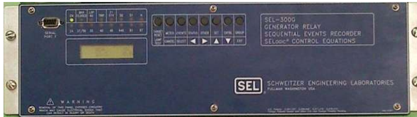
Figura 4.4 Protección de Generador SEL 300G
