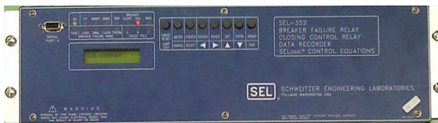
Figura 4.5 Protección de Falla de Interruptor.
