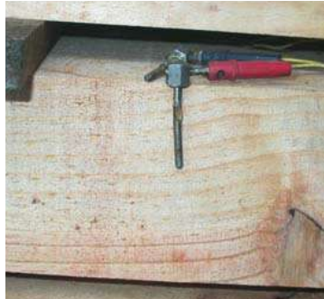
Figura 3.6 Electrodos incrustados en la Madera.
