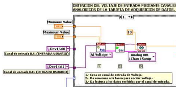
Figura 4.13 Configuración de Canales de Entrada.
