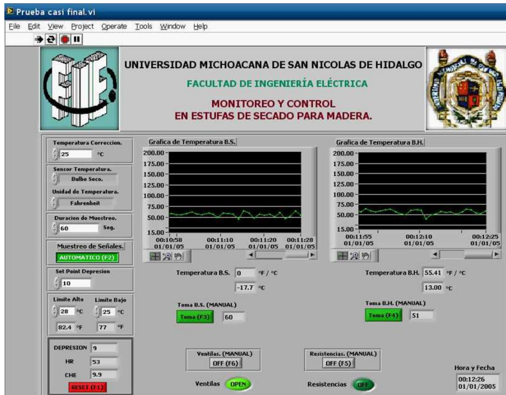
Figura 5.1 Programa en ejecución del Proceso de Secado para Madera.
