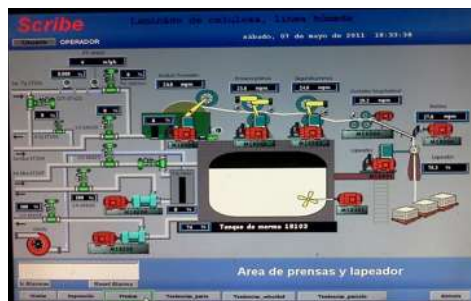
Figura 2.12 Pantalla de Control del Área de Laminado.
