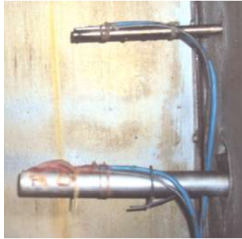
Figura 3.4 Termopares para obtener BS y BH.
