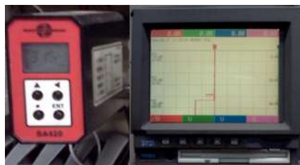
Figura 2.11 Convertidor y Graficador de Voltaje.
