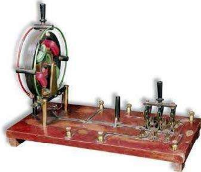
Figura 1.1 Modelo de la máquina de inducción bifásica diseñada por Tesla.
