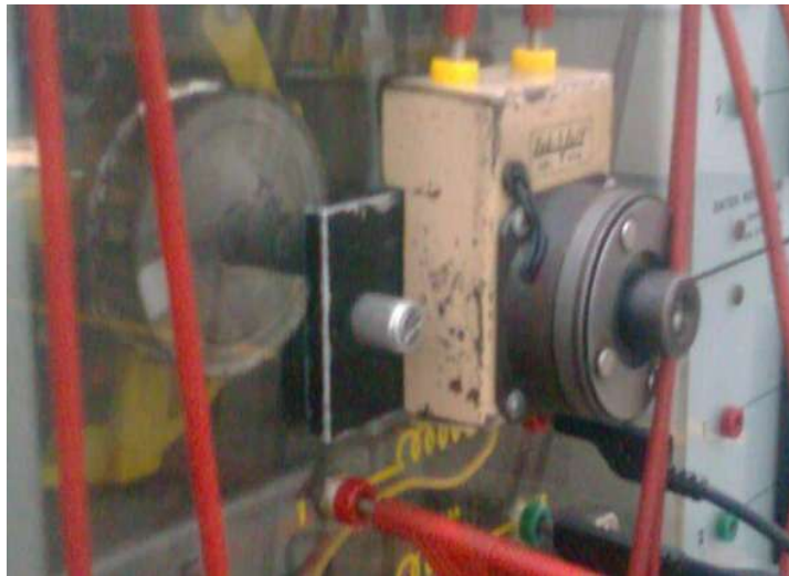
Figura 5.3 Freno electromecánico, para la prueba de rotor bloqueado.
