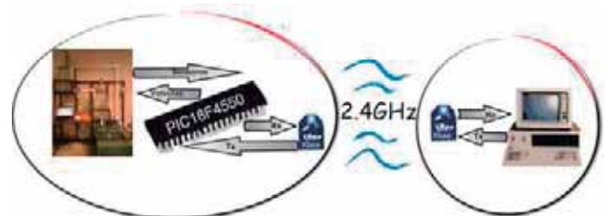
Fig. 13. Diagrama de bloques sistema de nivel de líquido con la tecnología Zigbee.
