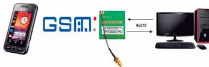
Figura 4.66: Esquema general de conexión entre una computadora y un microcontrolador mediante un módulo GSM SM5100B.
