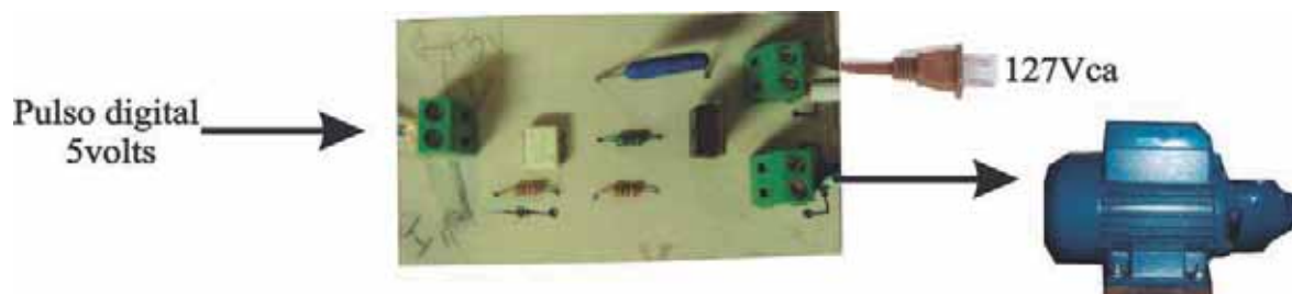
Figura 4.3: Esquema de conexión seguido para el control de la bomba de agua.
