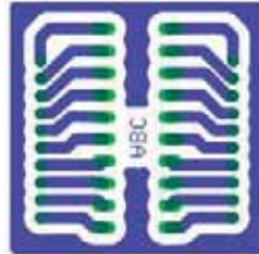
Figura 4.17: Esquemático del adaptador para el módulo Xbee®.
