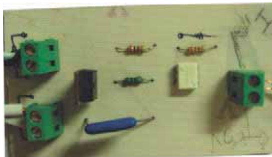
Figura 3.20: Aspecto real del controlador del motor de inducción.
