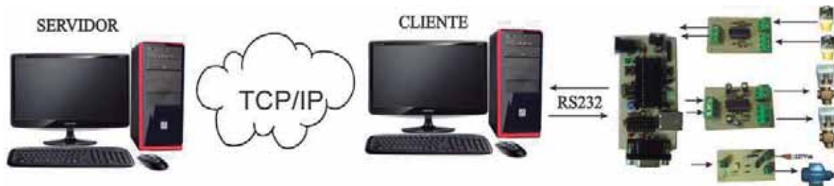
Figura 4.59: Monitoreo y control del sistema mediante la conexión TCP/IP.
