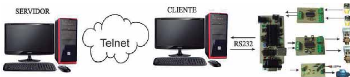
Figura 4.60: Monitoreo y control del sistema mediante la conexión TCP/IP.
