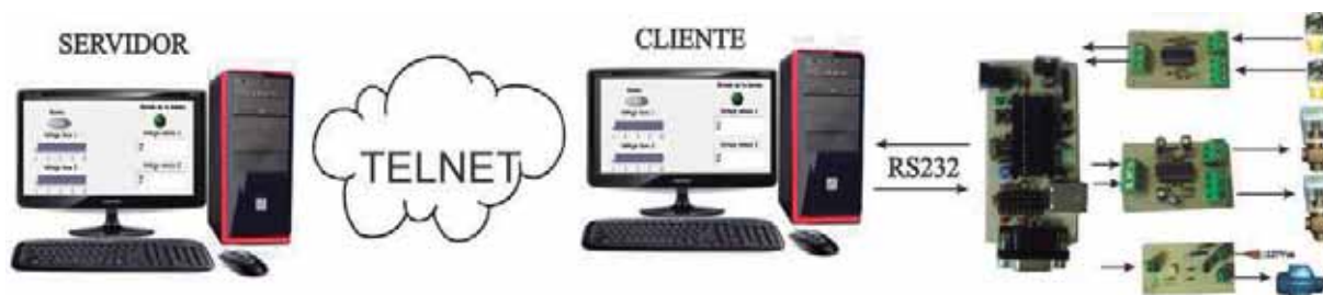
Figura 5.11: Esquema para el monitoreo y control con el esquema TELNET.
