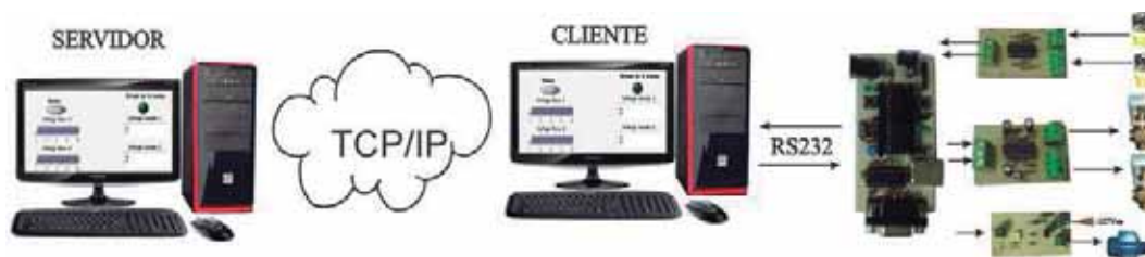
Figura 5.12: Esquema para el monitoreo y control con el esquema TCP/IP.
