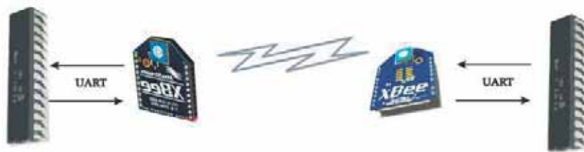
Figura 4.10: Esquema de comunicación entre 2 microcontroladores.
