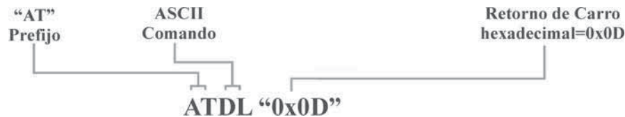
Figura 4.12: Sintaxis para leer comandos AT al módulo.
