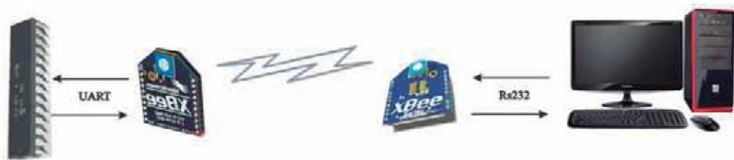
Figura 4.9: Esquema general de conexión entre una computadora y un microcontrolador mediante módulos Xbee®.
