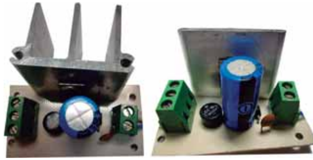
Figura 3.10: Aspecto real de la fuente de alimentación de los sensores de ultrasonido.
