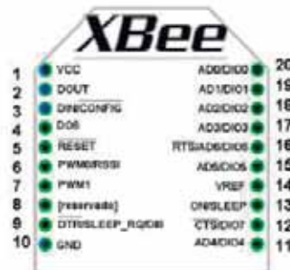
Figura 2.8: Vista superior del diagrama de pines del módulo Xbee®.
