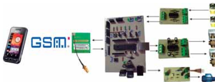
Figura 4.71: Esquema general de conexión del sistema mediante la tarjeta basada en el módulo GSM.
