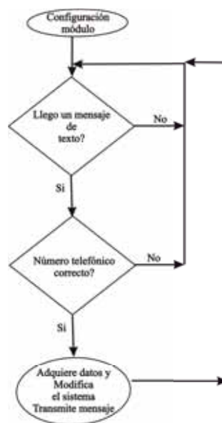
Figura 4.80: Diagrama de flujo del esquema implementado basado en esquema GSM.
