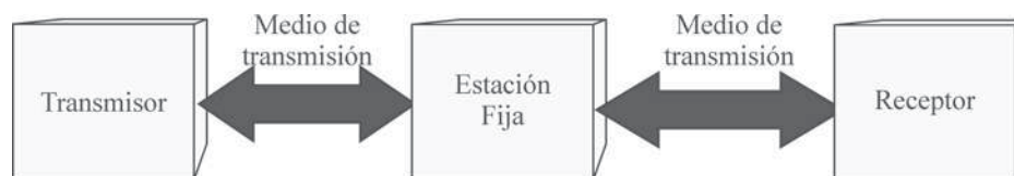
Figura 2.2: Diagrama de bloques simplificado para una comunicación a través de la red GSM.
