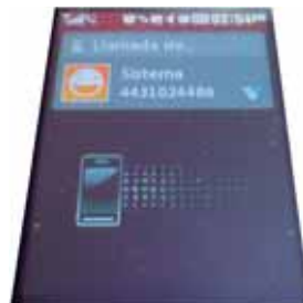
Figura 6.23: Prueba de transmisión de llamadas mediante el módulo GSM.
