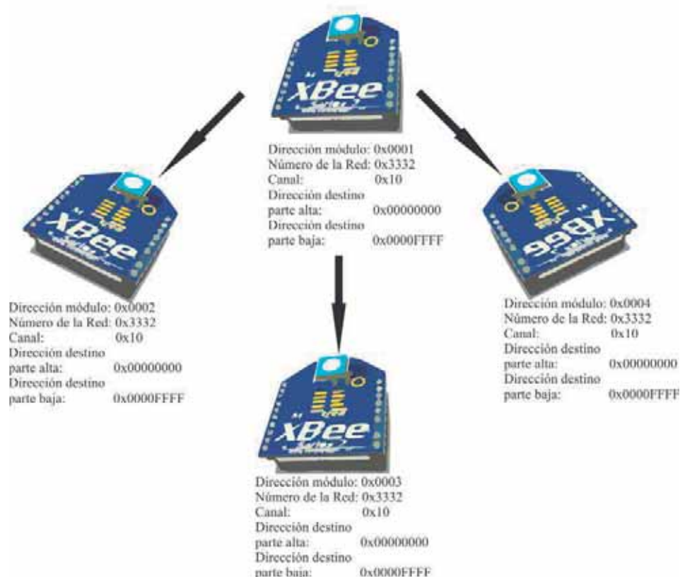
Figura 2.7: Configuración Broadcast en los módulos Xbee®.
