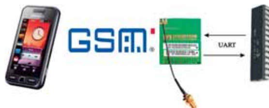
Figura 4.67: Esquema general de conexión entre un microcontrolador y el módulo GSM SM5100B.
