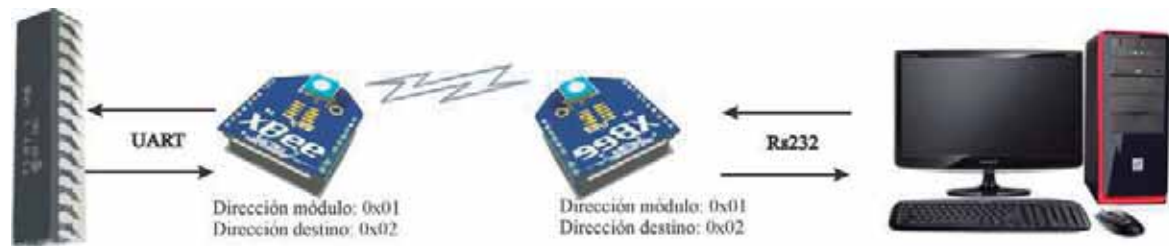
Figura 4.13: Direccionamiento de 16bits de dos módulos Xbee®.
